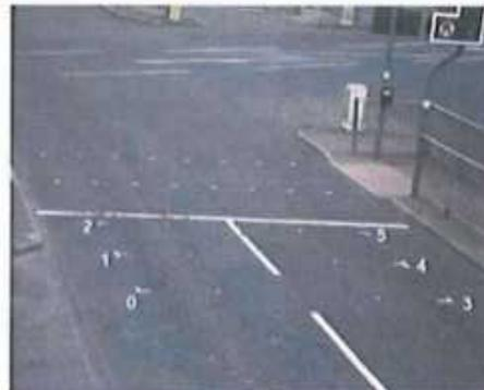
Las imágenes almacenadas en la cámara se utilizan luego para configurar el SSV.
