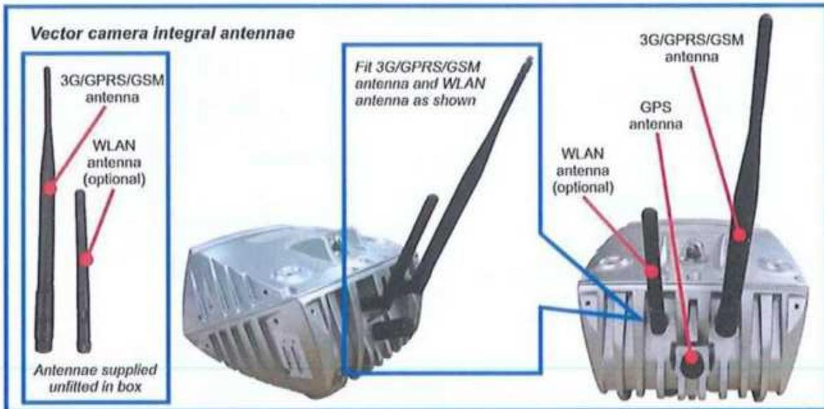
En ciertas ubicaciones de instalación, por ejemplo, donde la cámara está ubicada debajo de un puente, se encuentra una señal 3G débil, la recepción del GPS es deficiente, etc. Las antenas integrales se pueden quitar y se pueden usar antenas remotas, conectándolas a los conectores SMA en la parte posterior de la cámara, como se muestra a continuación.
