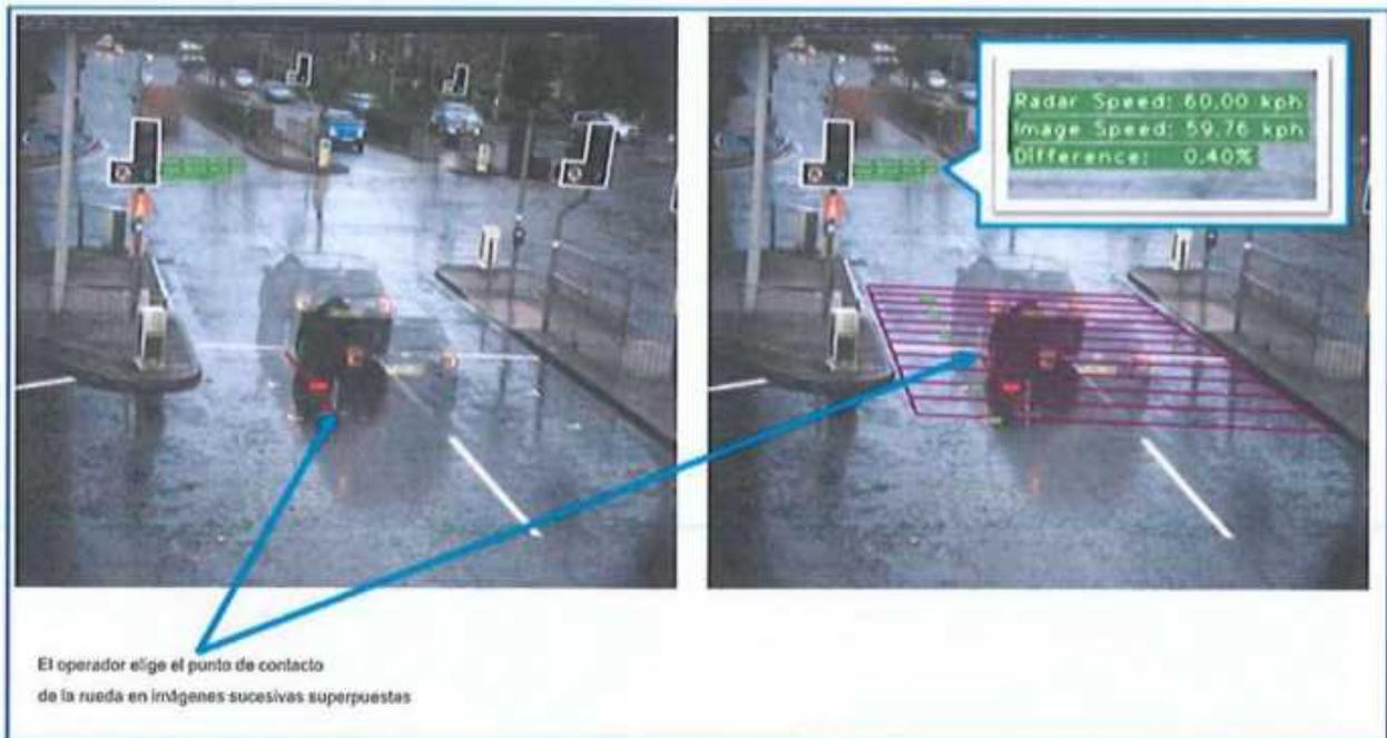
Luego, las coordenadas de la rueda se calculan en coordenadas del mundo real utilizando la matriz de homografía H
