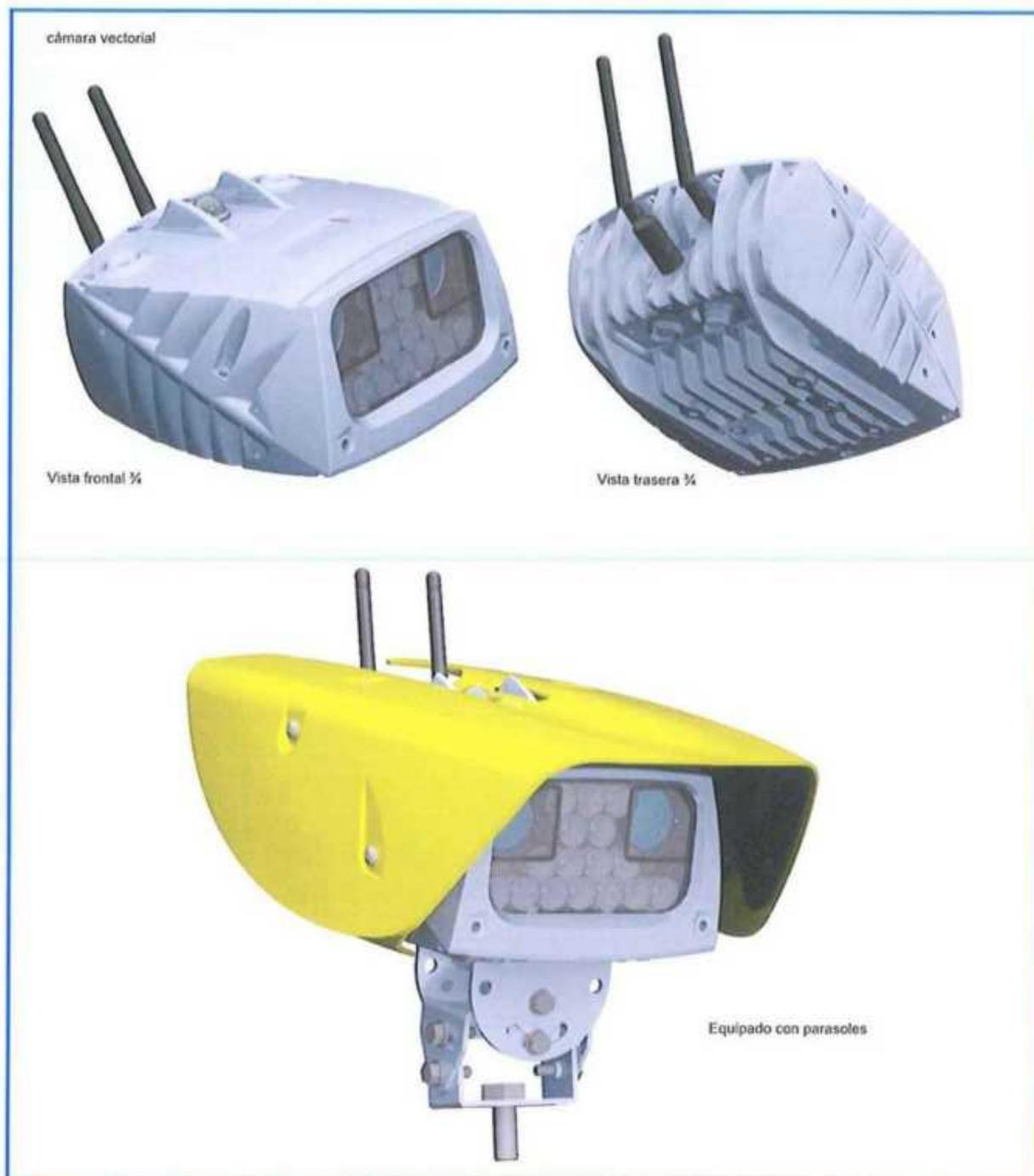
El gabinete mecánico consta de un gabinete de aluminio fundido a presión sellado con una clasificación de protección de ingreso (IP) de IP67. Los componentes internos clave que generan calor están unidos térmicamente al gabinete, que tiene aletas externas debajo y a los lados para ayudar a disipar el calor. El conjunto del módulo de la cámara y el conjunto del iluminador se encuentran detrás de una ventana de vidrio templado.
